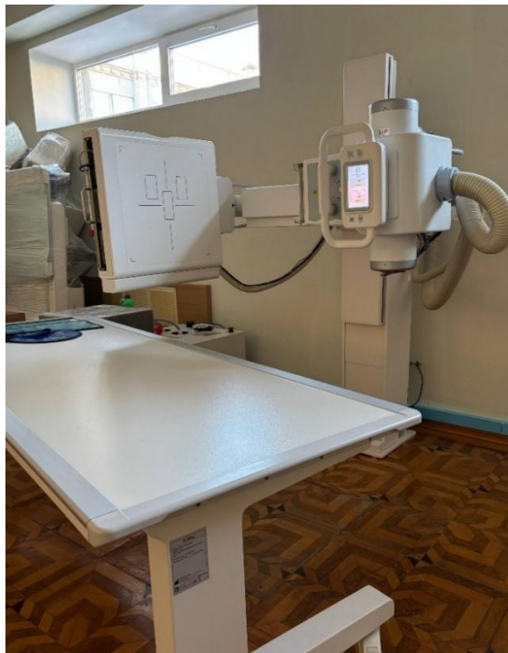
Рис. 2.6. Універсальний цифровий рентгенівський діагностичний комплекс Escoview 9 Plus Escoray, Республіка Корея, 2022 рік.
