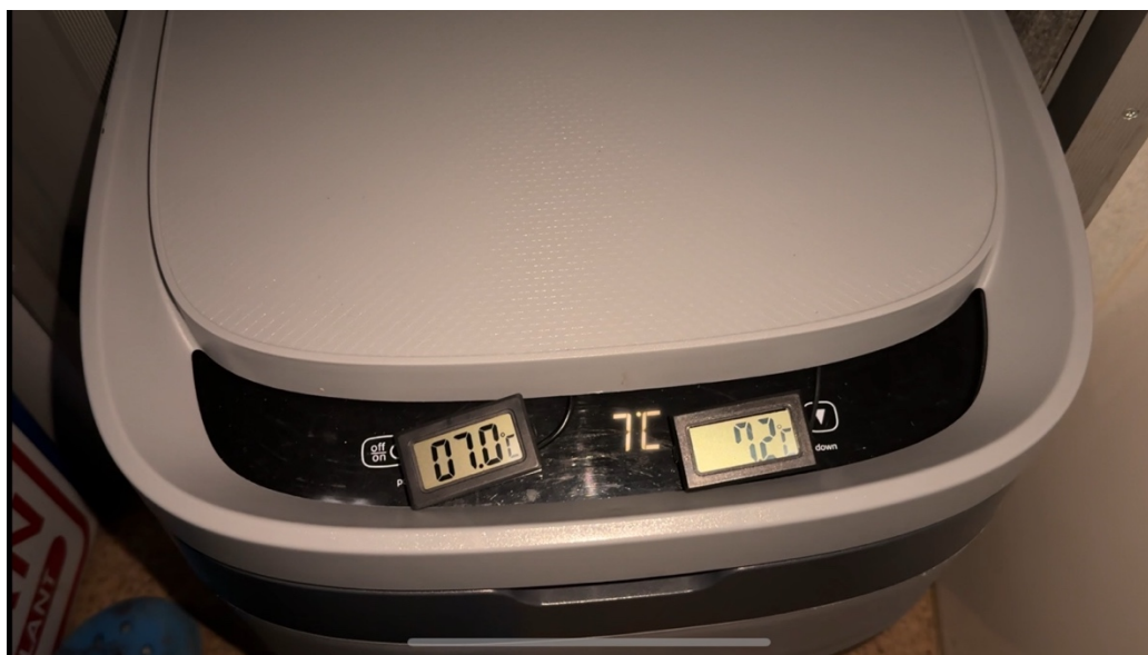
Рис. 2.1 Холодильний контейнер з контролем рівня температури за допомогою двох температурних датчиків
