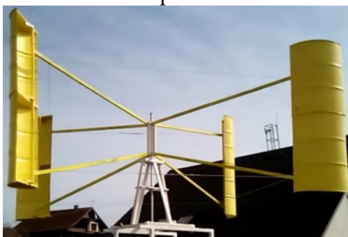
Рис. 1. 4-х і 12 лопатева ВЕУ з лопатями, виготовленими з металевих бочок
