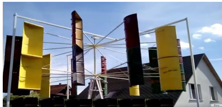
Рис. 1. 4-х і 12 лопатева ВЕУ з лопатями, виготовленими з металевих бочок
