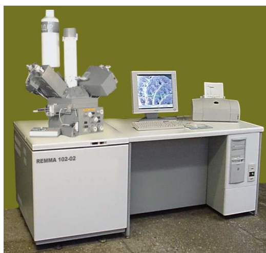
Рис.2.3. Растровий електронний мікроскоп-мікроаналізатор РЭММА-102-02. Дослідження рельєфу поверхні твердого тіла.
