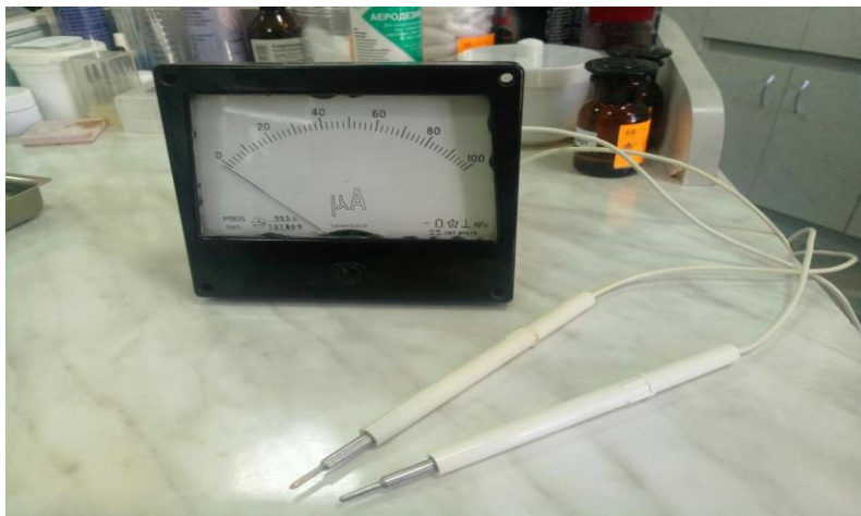
Рис 2.5. Мікроамперметр для визначення гальванічних струмів у ротовій порожнині.
