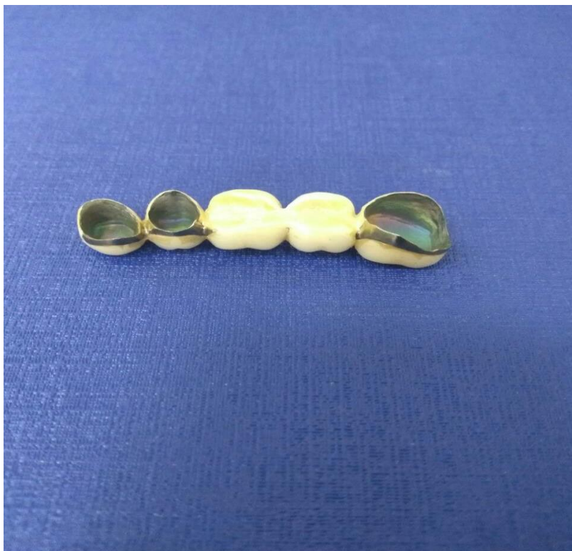
Рис. 5.8. Готові металокерамічні конструкції із нанесеним захисним ZrO_2 покриттям, вигляд з внутрішньої поверхні.
