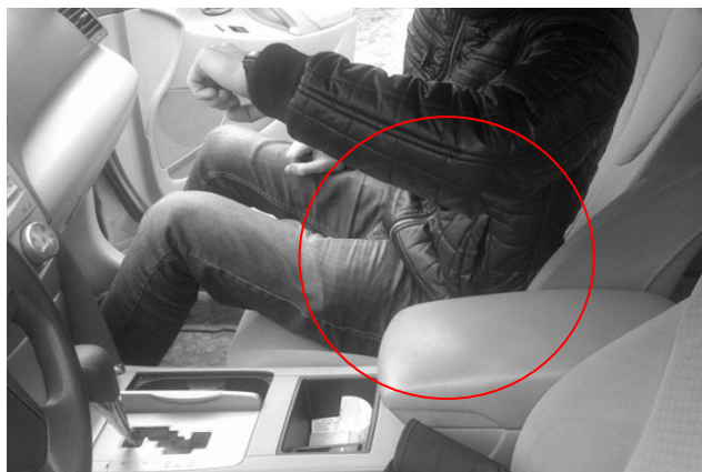
Рис. 6.3. Моделювання механізму травмування пасажирів переднього сидіння автомобіля для випадку зіткнення іншого транспортного засобу з лівим бортом автомобіля (червоним колом окреслені деталі салону і частини тіла пасажирів, які вступають в первинний контакт).
