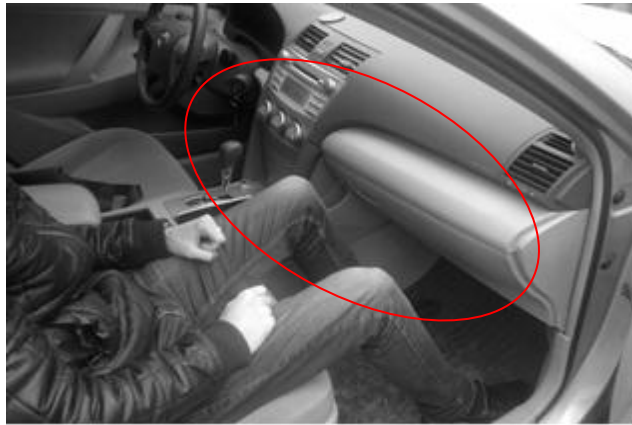
Рис. 6.2. Моделювання механізму травмування пасажирів переднього сидіння автомобіля для випадку лобового зіткнення (червоним колом окреслені деталі салону і частини тіла пасажирів, які вступають в первинний контакт).
