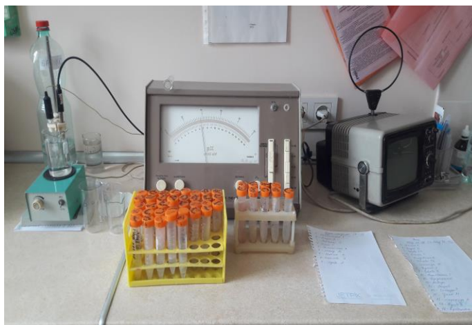
Рис. 2.5 Дослідження концентрації фтору у ротовій рідині за допомогою іонселективного електроду ЭЛИС-131F
