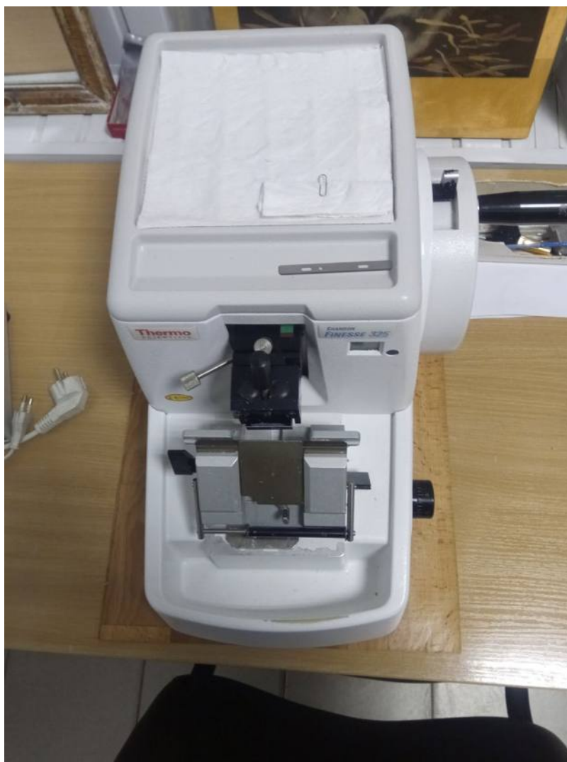
Рис 2.14 Ротаційний мікротом із змінними лезами.
