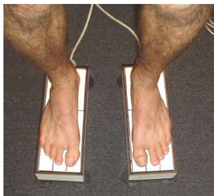
Рис. 2. 20. Розташування стоп на електротензодинамометричній платформі
