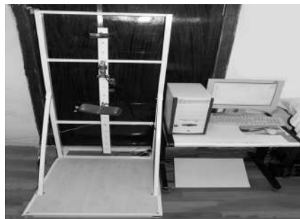
Рис. 2. 19. Загальний вигляд динамометричного столу та динамометричного полігону
